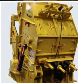
En haut : Trio® WIH 4034, installation portable de broyage à percussion en circuit fermé
