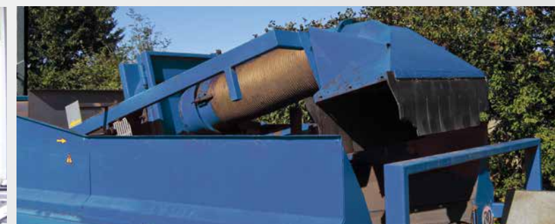
Séparateur aéralucique sur la table des grossiers
