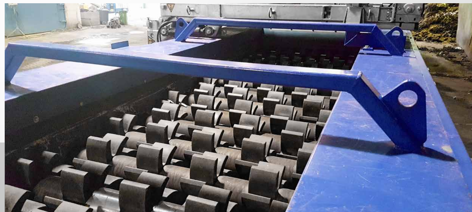
Construction en cassette de la table de criblage
