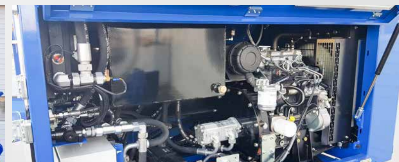
Moteur diesel 25 kW avec une très basse consommation 8 de carburant
