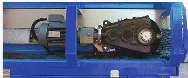
Entraînement électrique de la trémie
