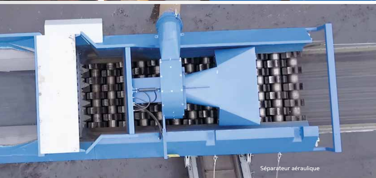
Système d'entraînement à rouleau cranté
