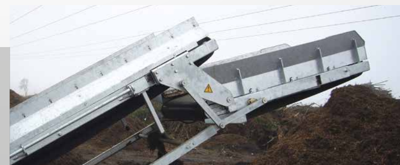
Tapis balistique pour la séparation des pierres à l'arrière
