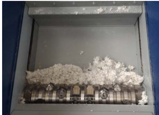
Vue intérieure de la chambre de broyage
