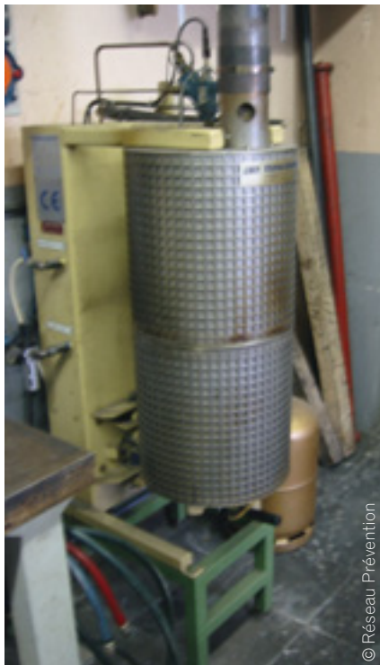
Four à pyrolyse pour le décapage des buses
