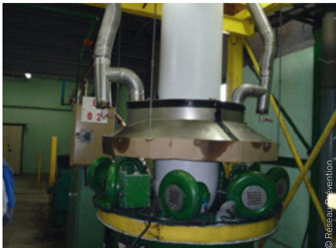
Dispositif de captage sur la filière
