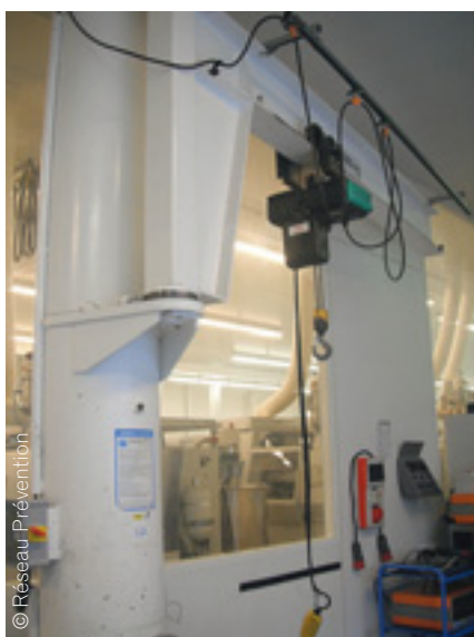
Palan pour manutention des moules
