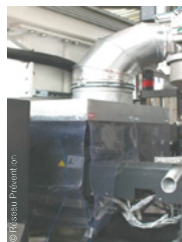
Dispositif de captage - Quatre bavettes en place
