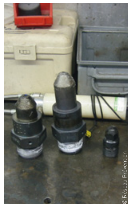
Buses d'injection à traiter
