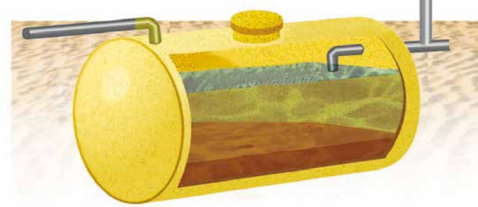
FOSSE TOUTES EAUX (FTE)
