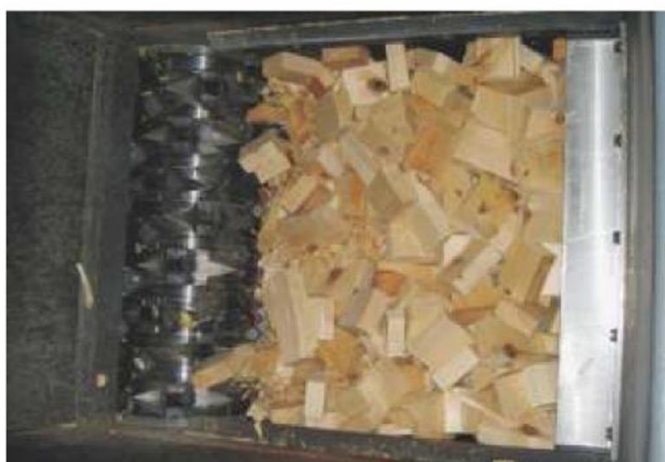
Vue sur la trémie du broyeur en action sur du bois
