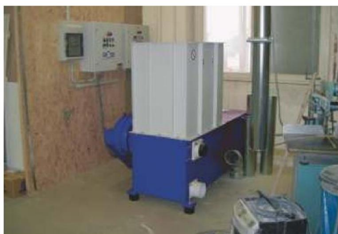
Broyeur en connexion avec un système d'aspiration
