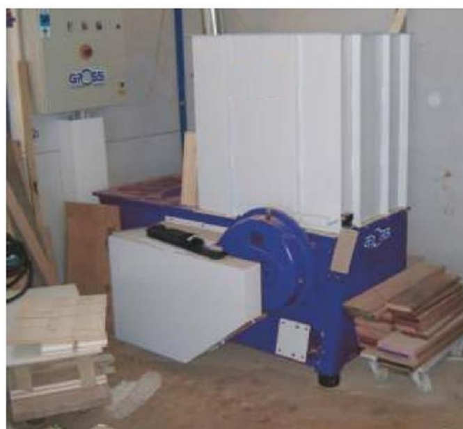
Mise en service du broyeur
