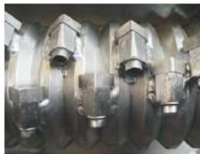
Rotor profilé avec supports de lame soudés
