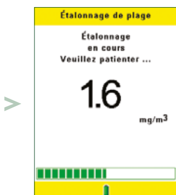
Étape 2 : Étalonnage avec 1 seul appui de bouton
